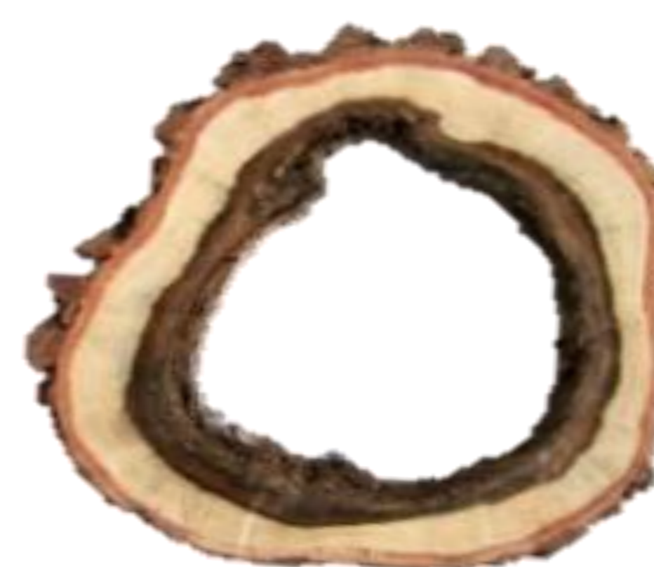
(2D a 3D tomogram poškodennej dreveniny so zníženou stabilitou)
